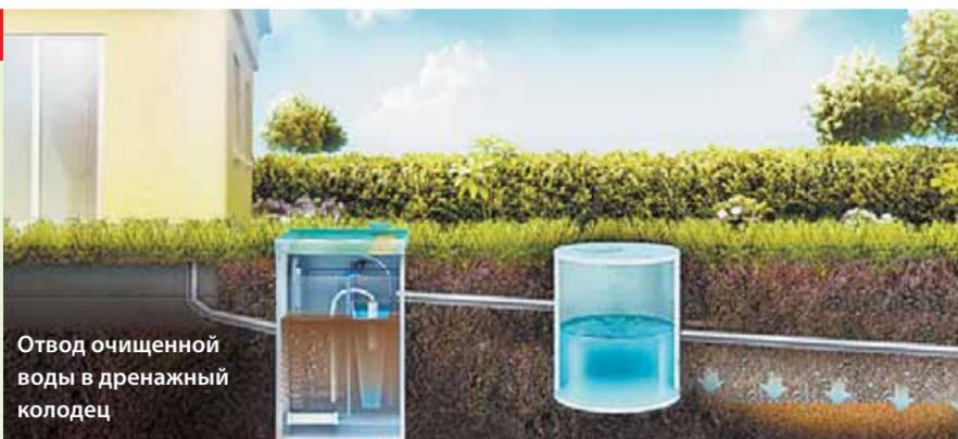
Отвод очищенной воды в дренажный колодец
